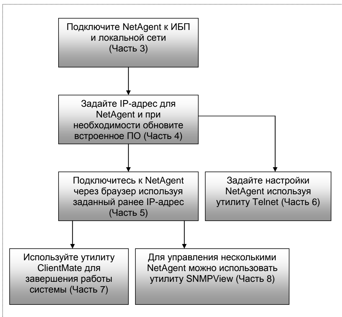
Рис.4. Блок схема установки NetAgent
